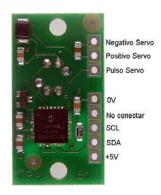
Este sensor junto al servo, realiza un barrido en el que empieza a detectar el foco de calor a través de sus píxeles, así como la temperatura ambiente. La lectura de las temperaturas se realiza a través de registros:
