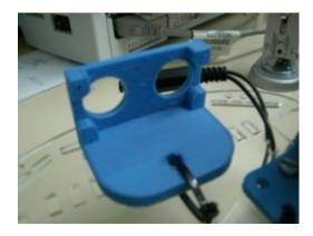
Soporte para Arduino: Es un soporte creado mediante una impresora 3D para poder colocar el Arduino.
