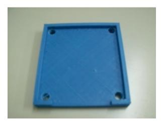
Soporte para Sensor de Distancia: Es un soporte creado mediante una impresora 3D para poder colocar el Sensor de Distancia.
