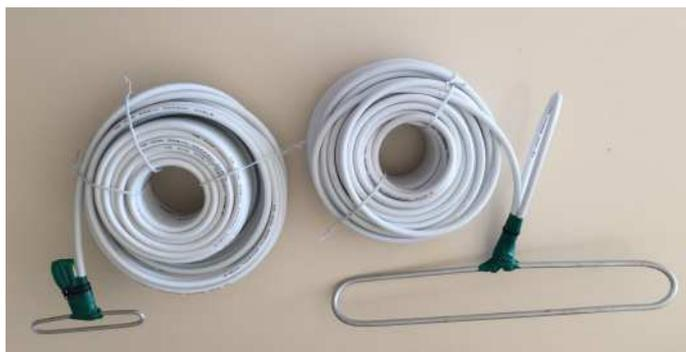
Para ello procedemos en primer lugar al desenrollado del cable para evitar dobleces y de esta forma que se produzcan cambios o alteraciones en la impedancia del cable.
