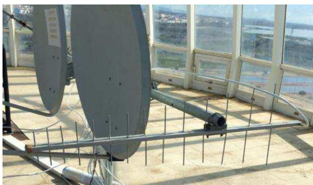
Disponiendo de estas antenas, el propósito es conectar la antena Yagi en principio a uno de los ordenadores de la sala mediante un RTL-SDR. Disponemos de los siguientes equipos y aparatos:
