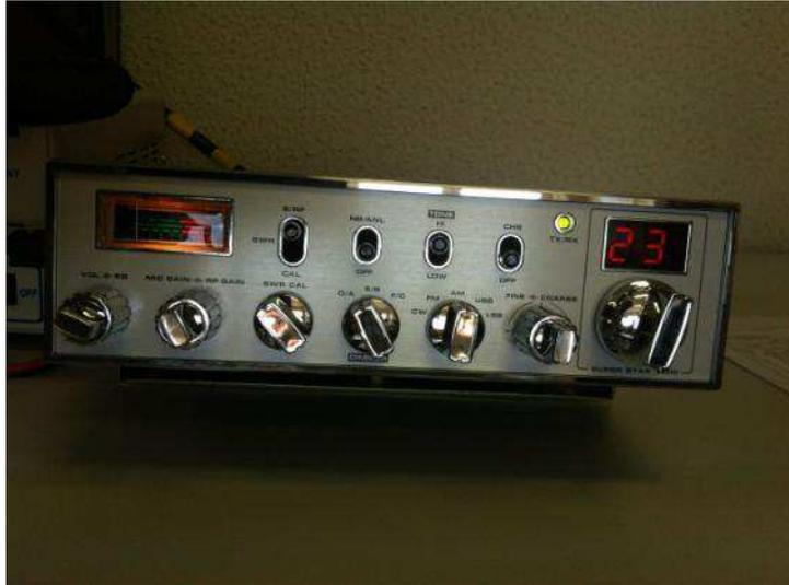
Una vez observado esto, buscamos en la radio el canal 27 o “canal de los camioneros”, en el que efectivamente comprobamos que, para el cable coaxial que creaba ruido (el conectado a la antena), escuchamos a los usuarios, mientras que para el otro (no conectado a la antena), no se aprecia nada.
